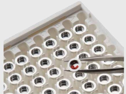
Die Kennzeichnung sorgt für eine definierte Probenposition
